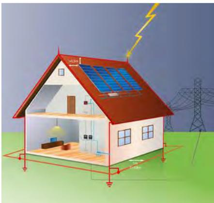
Abbildung 6-12: Blitzschutz für Photovoltaikanlagen (Quelle: [www.photovoltaik.org](http://www.photovoltaik.org))
