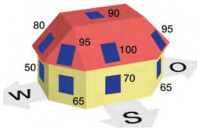
Abbildung 6-1: Einfluss der Ausrichtung einer Photovoltaik-Anlage auf den Stromertrag in Mitteleuropa (Quelle: [www.conrad.at](http://www.conrad.at))
